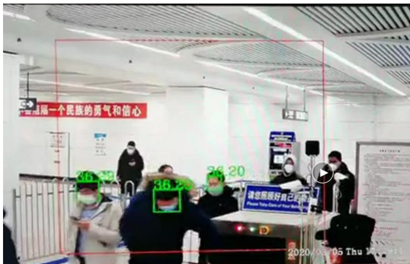
图示：可见光图像显示叠加人体温度值
